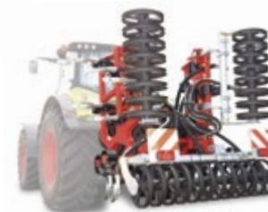
Abb.: FZG geklappt mit U-Profil-Walzen
