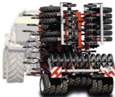
Abb.: APER G6000, geklappt mit U-Ring-Walzen.
