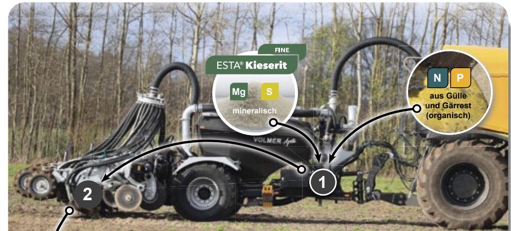
Abb.: PL/ENTRY 3000 mit GRANU-Inject und CULEX CL 12.50
