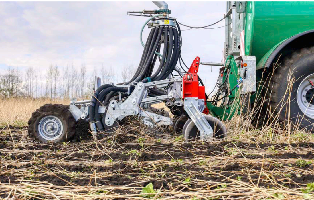
Der Culex von der Seite: vorne am Gerät gut zu erkennen das Scheibensech, das den Boden aufschlitzt. Dahinter arbeiten zwei v-förmig angeordnete Sternradscheibenräder, die aufliegendes Pflanzenmaterial zur Seite räumen. Dahinter folgt das Parabelschär mit den beiden Gülledosierrohren. Zum Schluss rollen die Druckräder zur Rückverfestigung des Bodens.
