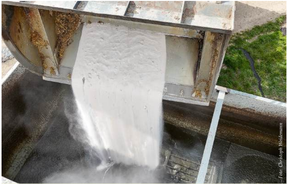
In dieser Praxislösung zur Kieserit-Einmischung auf dem Betrieb Rave-Dietz in Ausacker (Schleswig-Flensburg), wird Kieserit fein kurz vor der Ausbringung in einem Container mit integriertem Rührwerk in das Gärsubstrat eingemischt.
