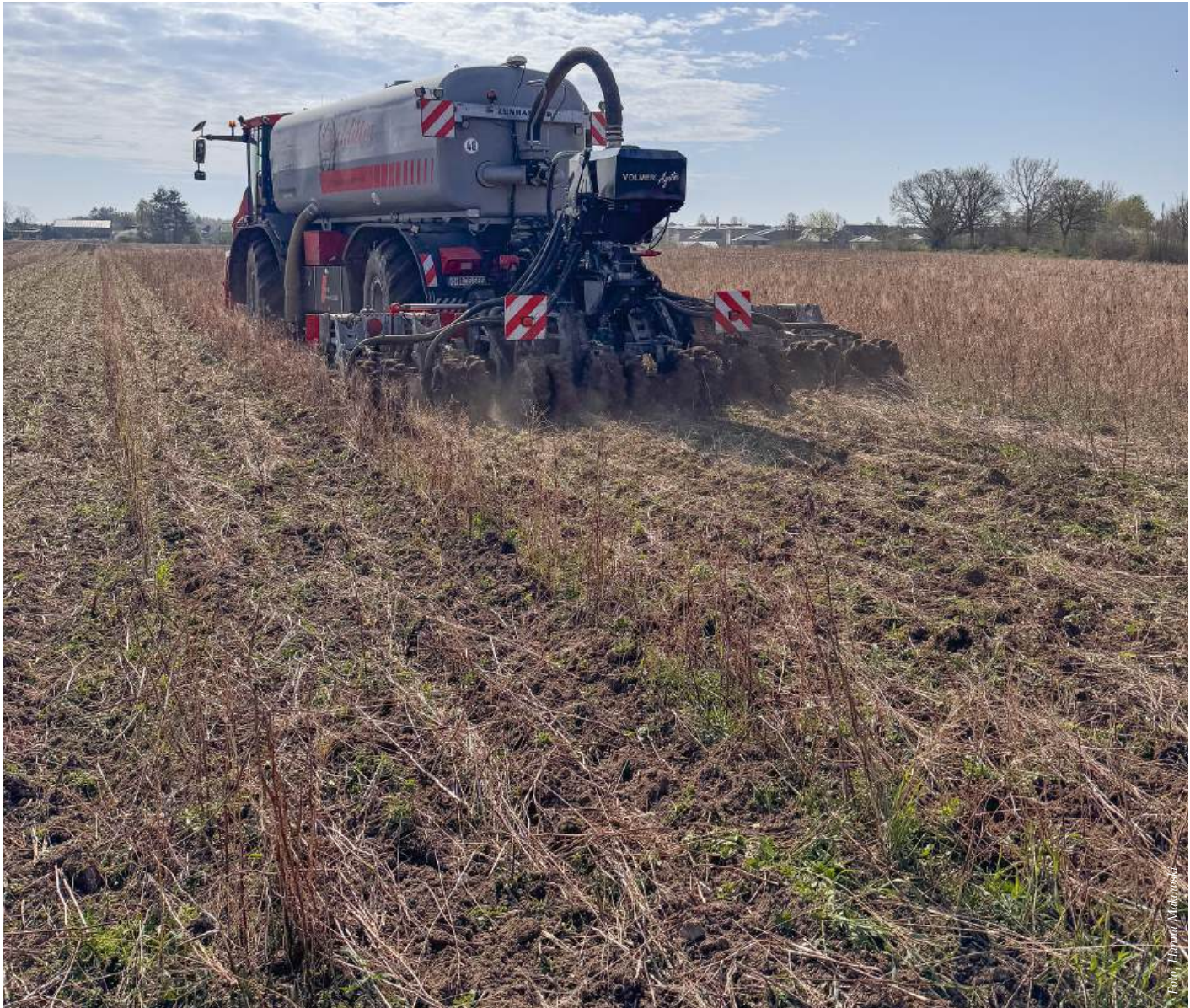
Das Lohnunternehmen Schlüter aus Nüchel (Ostholstein) setzt eine Düngerschleuse ein, die direkt am Strip Till Gerät angebaut ist und Kieserit fein unmittelbar vor der Ausbringung in die Gülle einmischt.
